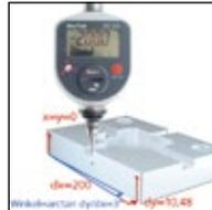
Bestimmung und Korrektur der Werkzeugausrichtung
